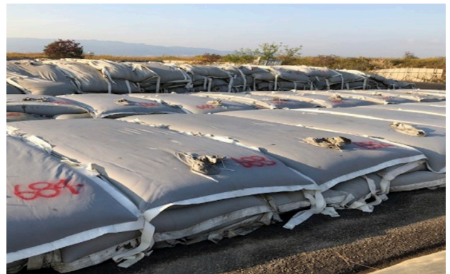
PCB汚泥を積めた袋 (筆者撮影)
