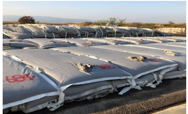
PCB汚泥を積めた袋 (筆者撮影)
